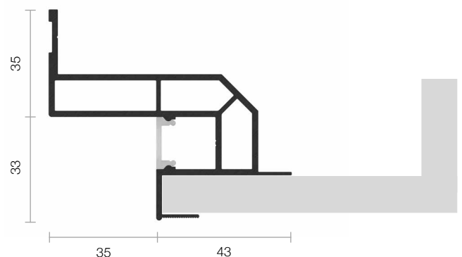
Schattenfugenprofil mit Lichtvoute aus Trockenbauplatte in 12,5 mm Stärke
